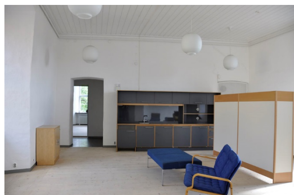
73– 79. Rum 202 under och efter renoveringen. Ett pentry monterades på en fristående skiva för att minska borrhål. Det äldre brädtaket är bevarat. Portalen t.h. har satts igen med ett ventilationsgaller.
