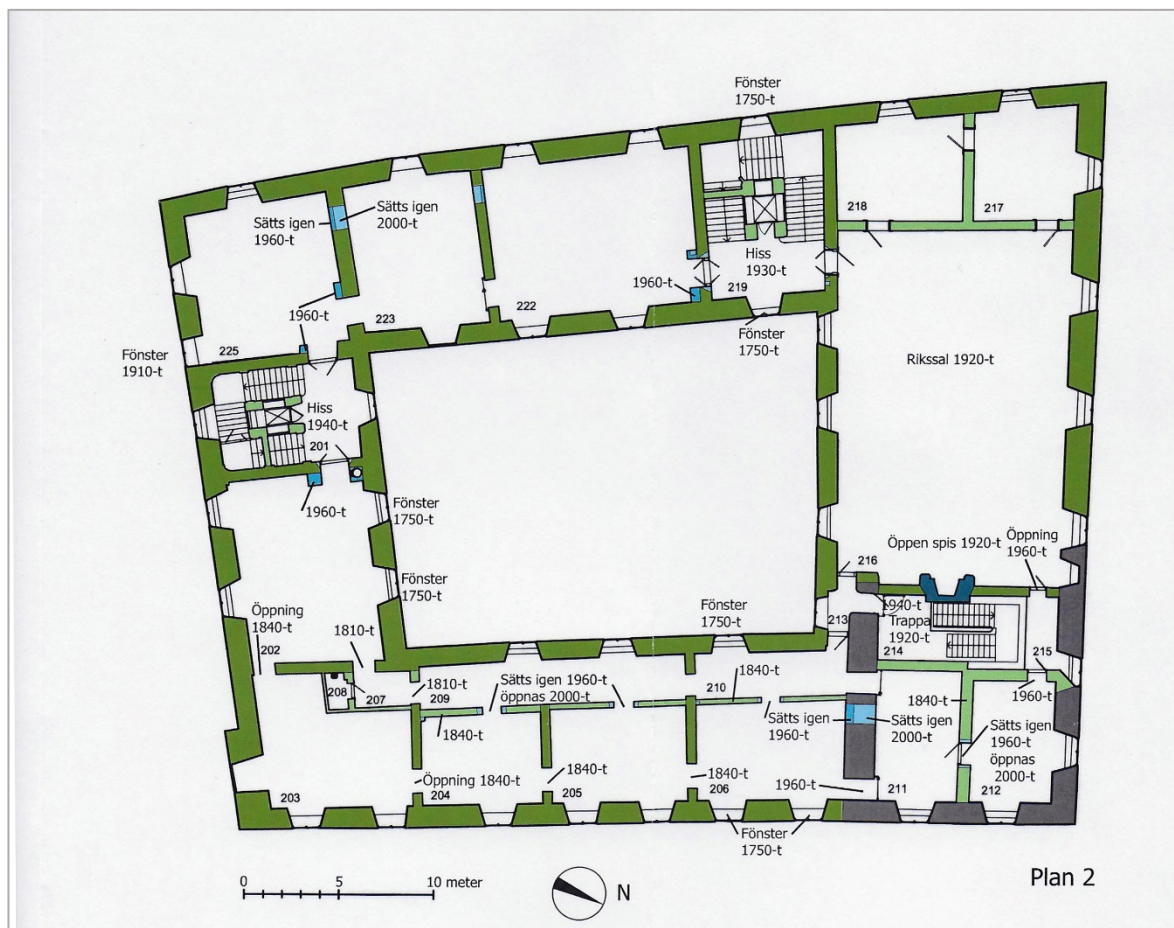
4. Planritningar över aktuellt våningsplan. Rummen som omfattas av ombyggnationen ligger i östra, södra och västra längan. Ritning från Vårdprogram Västerås slott U1. Bach arkitekter ab. Skala 1:300
