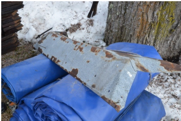
Den äldre rostangripna nockplåten. Vlm_kmvFE-2593
