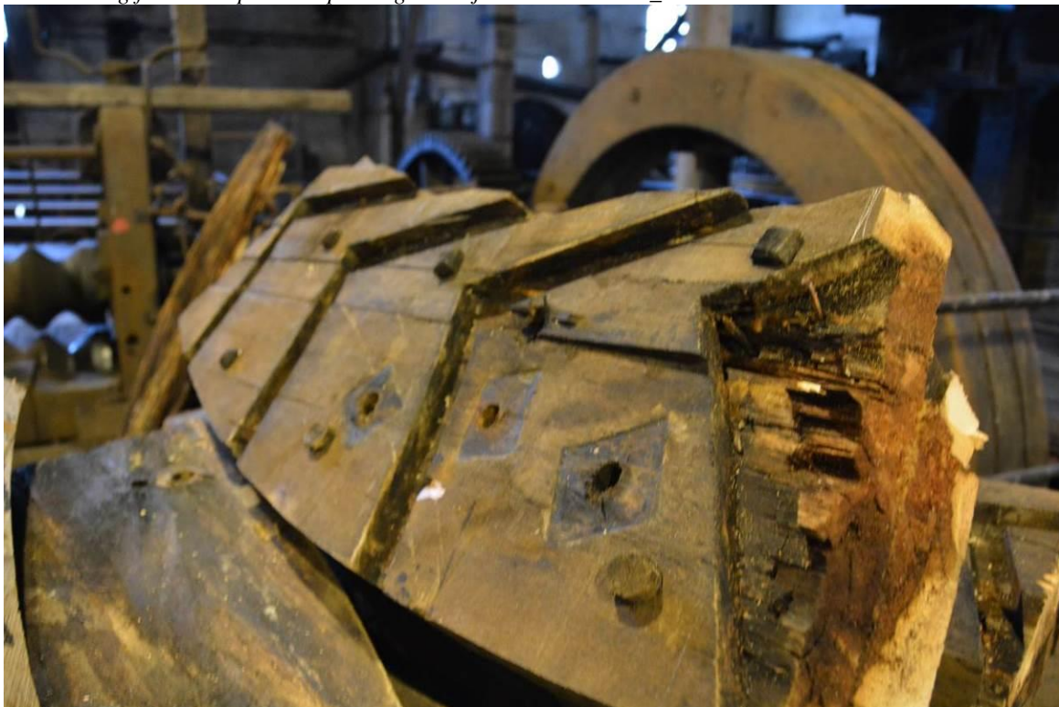
En av hjulets löt, dvs de böjda träsegment som håller samman ekrarna ytterst. BildID: Vlm_kmvSB-2583.
