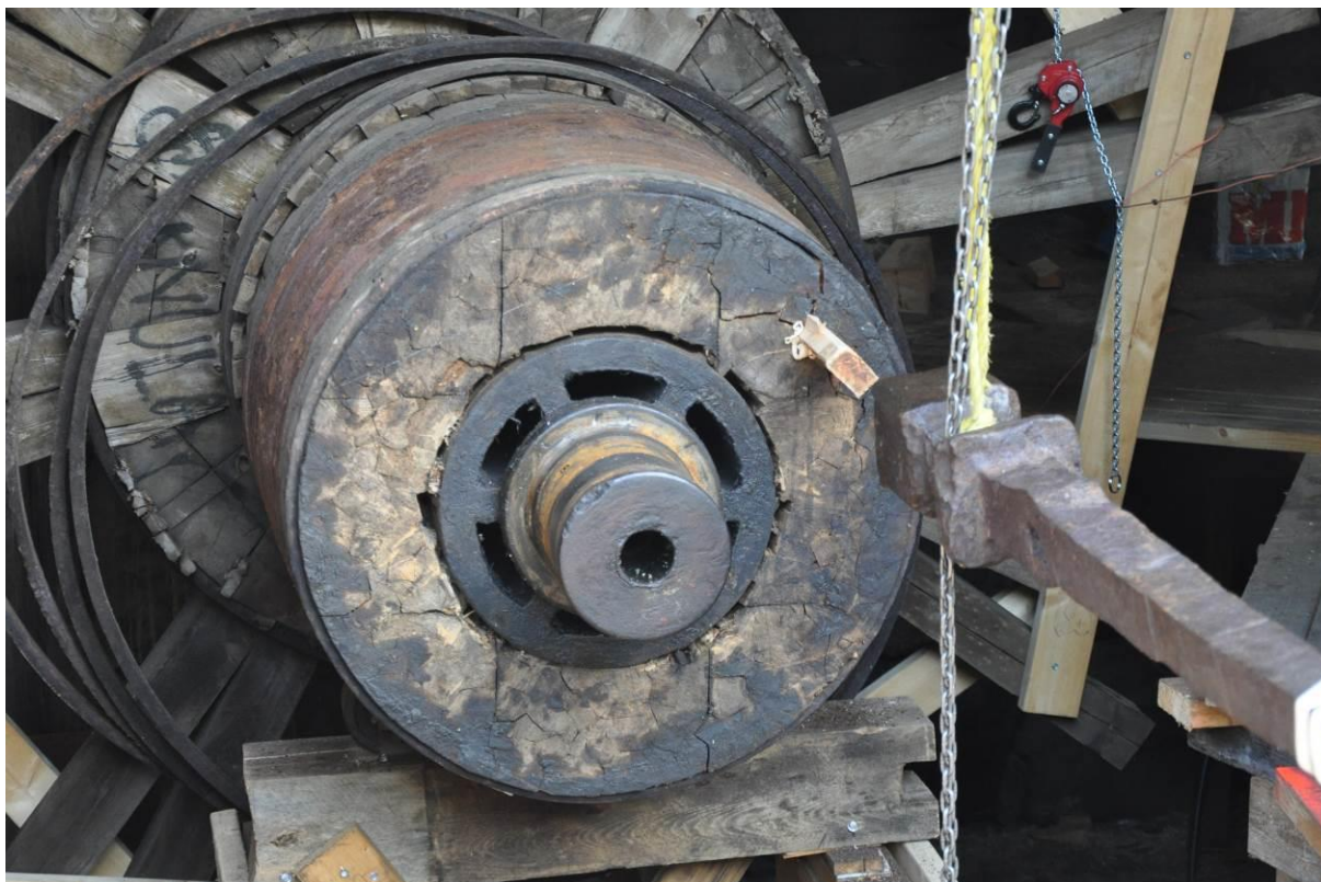
Kilstöt vid kilning av lagerstocken. Foto från Mattias Hallgren.
