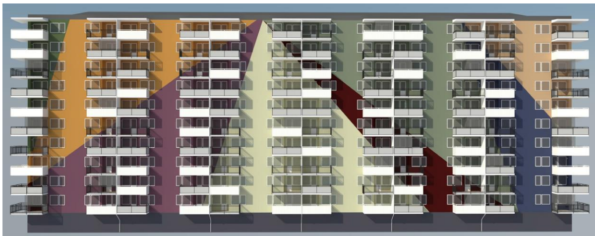
Förslaget till utbyggda balkonger, nya balkongfronter och nya fasadkulörer på skivhuset inom Lövträdet 1. Utdrag från: Balkongrenovering. Brf. Kolarhagen, Anders Holmberg arkitekter, 170616.
