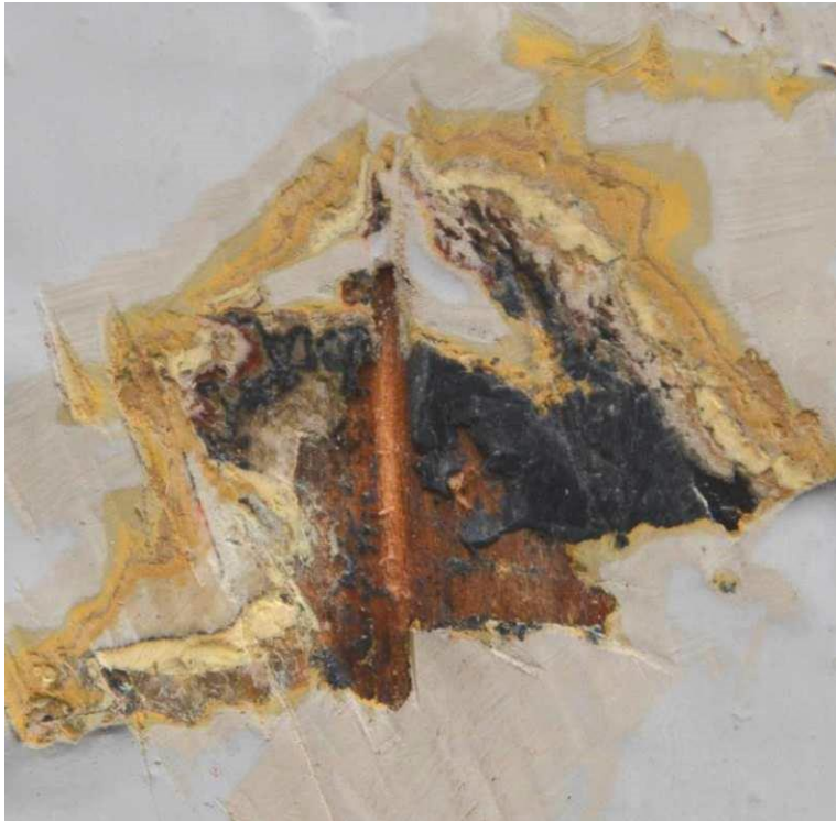
Bild 4 Lagren brunsvart, grön umbra, engelsk röd, vitgrå, ockra, ljusgul, crémfärgad och klargul (innifrån och ut). Vlm_kmvEK-738.
