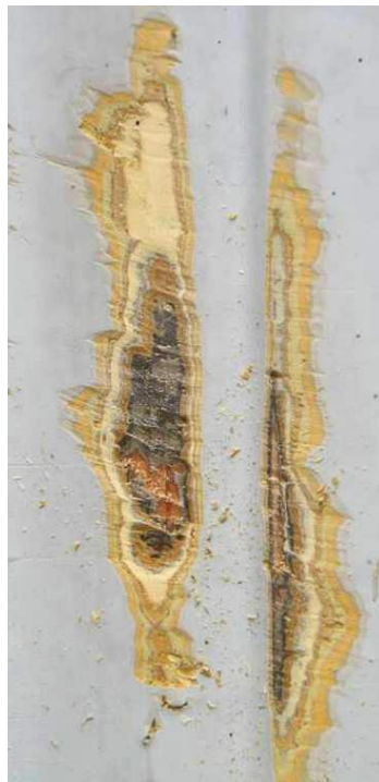
Bild 8 Profilerade fönsterfoder med lagrena grå, grön umbra, svartbrun, två olika ockra, vitgrå, ljusgul, ockra, ljusgul och klargul. Vlm_kmvEK-757.
