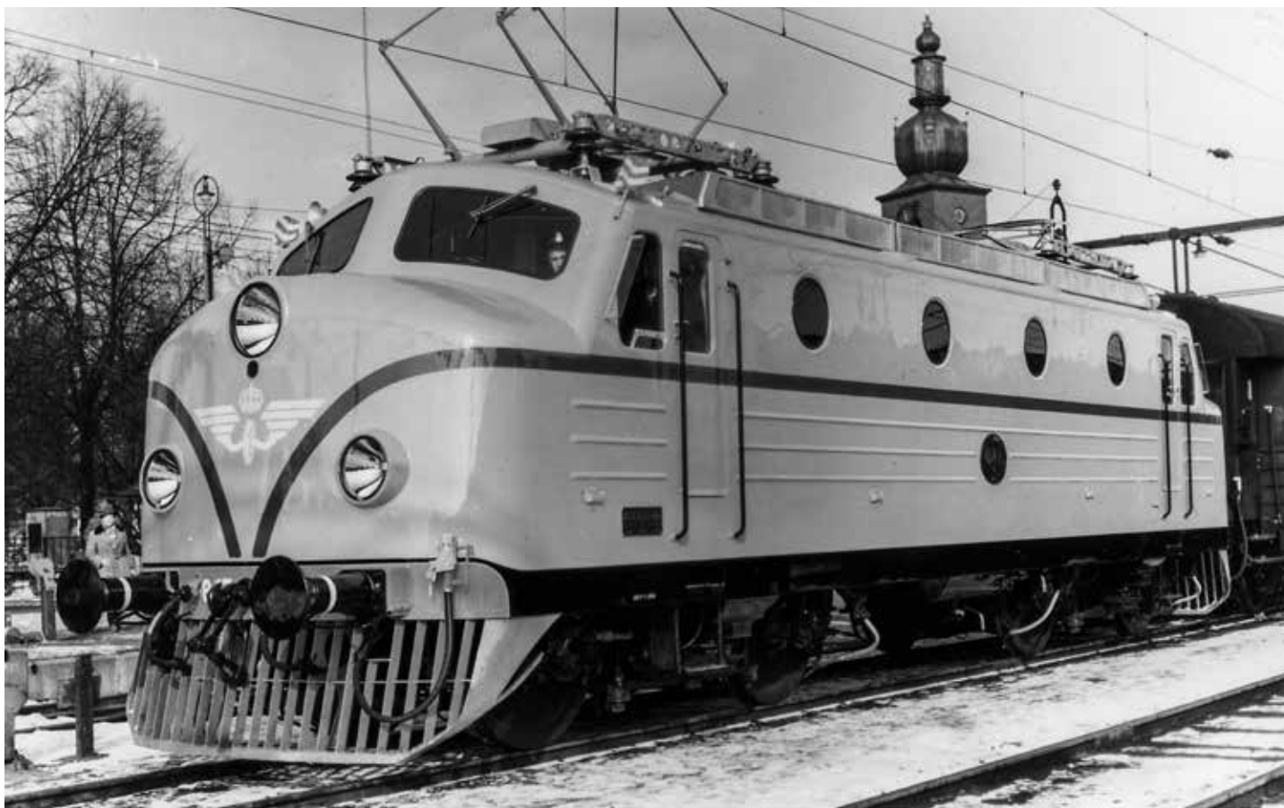
^ ASEA i Västerås spelade en central roll för den tekniska utvecklingen av järnvägen och lokomotiven sedan eldriften införts. Rapidloket från 1955 kunde köras i 150 km/h. Foto: Järnvägsmuseet.
