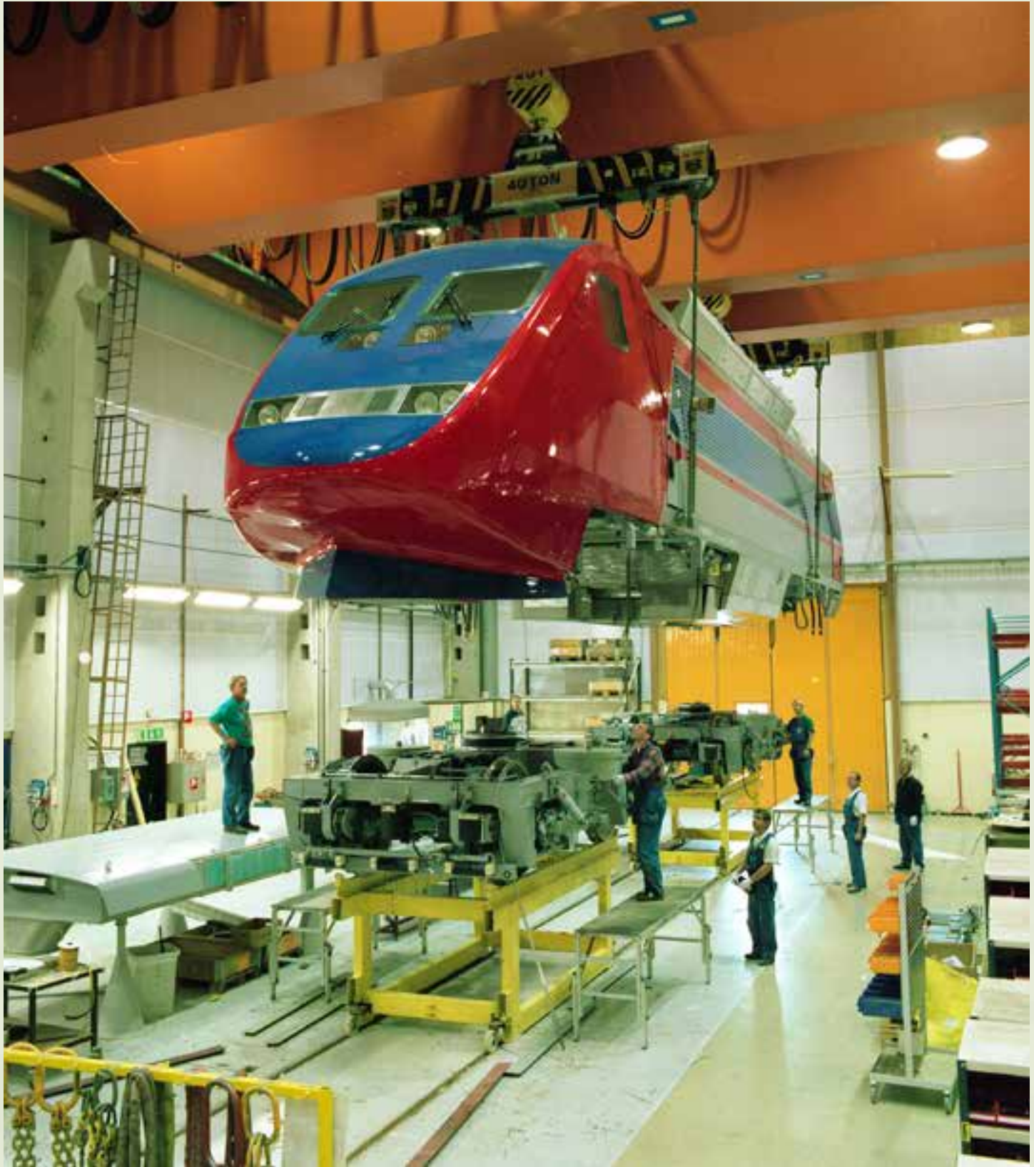
^ Den sista X2 (drivenheten för X2000) sätts på sina boggier i Lokverkstaden i Finnslätten år 1997 inför leverans till Guangshen Railway Co. (GSRC) i Kina.
