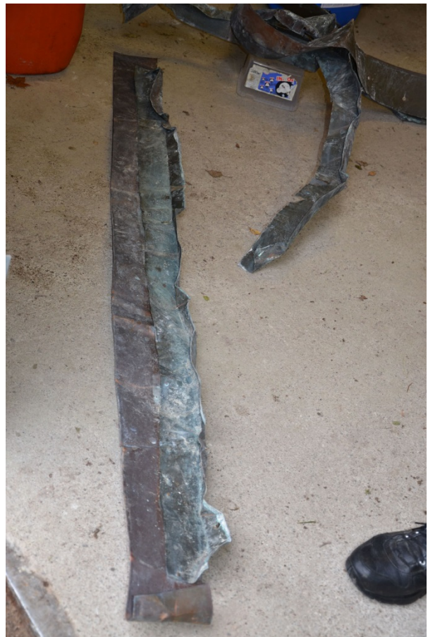
53-54. Droppblecken över urtavlan bidrog till felaktig vattenavrinning. Äldre bleck efter nedtagning.
