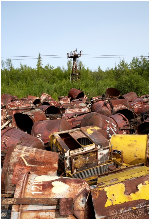
Korgar i hög. I mitten syns en gul inspektionskorg som användes vid t ex reparation av linbanan. Foto: Lasse Fredriksson
