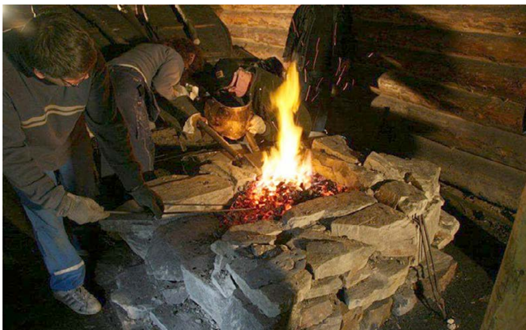
Figur 7. Rekonstruerad färskningshärd vid ett färskningsförsök vid Nya Lapphyttan år 2010. Foto: Föreningen Järnet på Lapphyttan.
