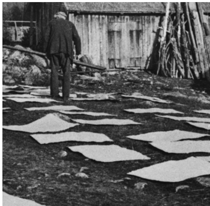
↑ Papper lufttorkas i långa rader på Ösjöfors handpappersbruk, Vimmerby, Kalmar län. Okänt årtal. Foto: Tekniska museet.
